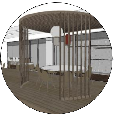
"La canopée - Table de 8 personnes" Plafond suspendu en lames de bois ajourées : délimite une zone de repas pour 8 personnes
